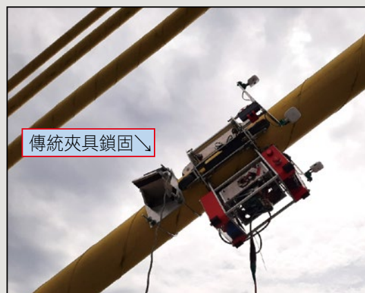
圖6 爬索車於國道四號豐潭段斜張橋現地測試照
