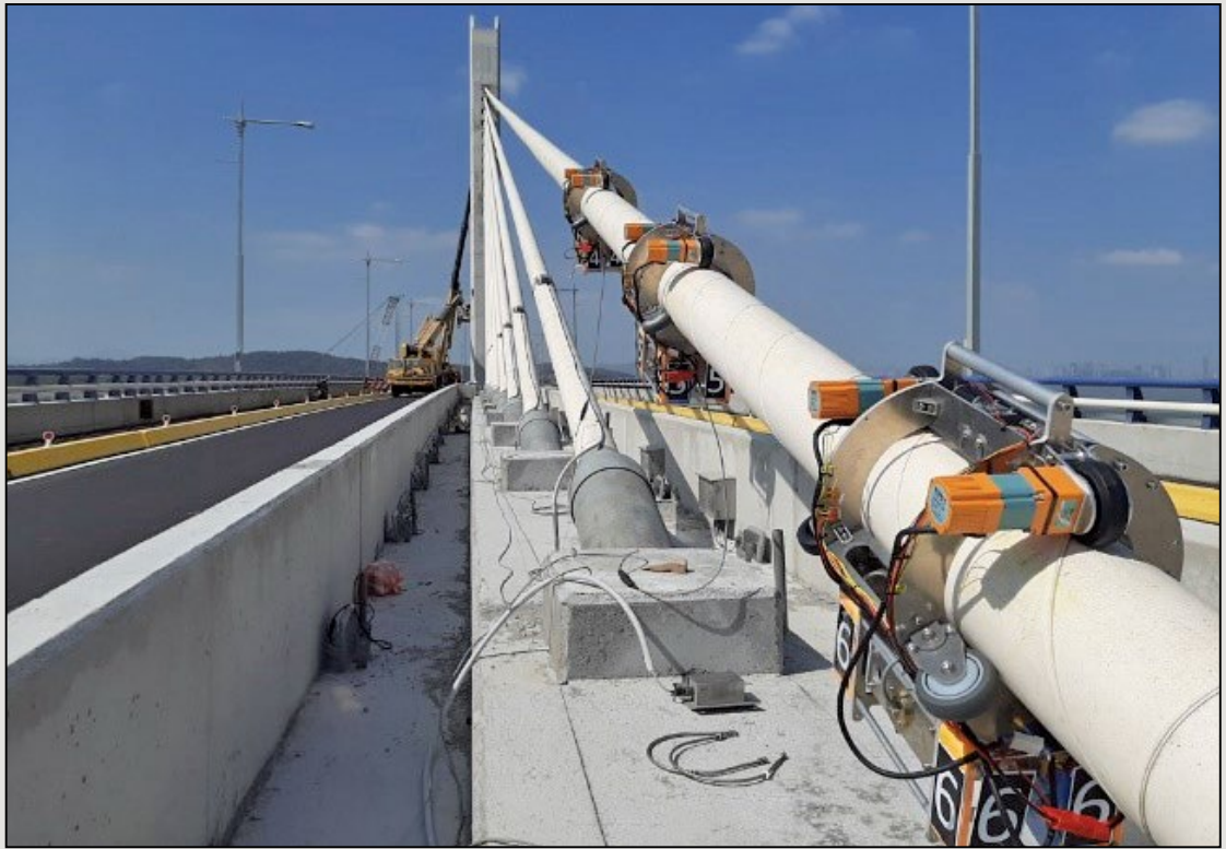
圖8 爬索車於金門大橋現地測試照
