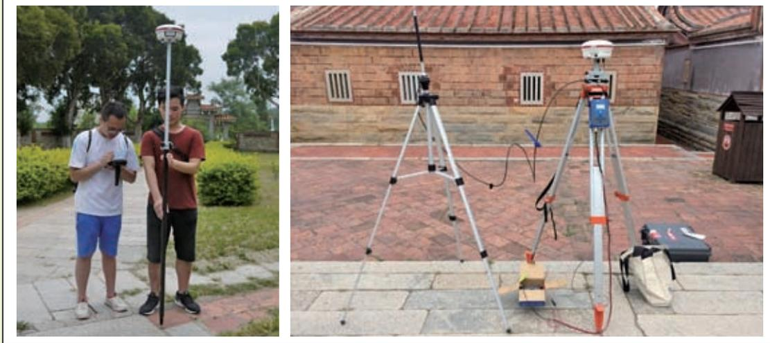
圖3 e-GNSS測量(左)、RTK測量(右)
